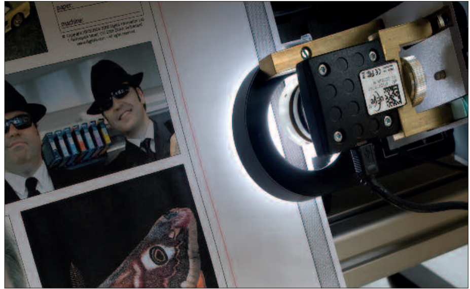
Das neuartige Kontrollsystem mit Videokameras erlaubt den Druck auf Vorder- und Rückseite mit hoher Registerpräzision bei ungeschnittener Papierbahn.
